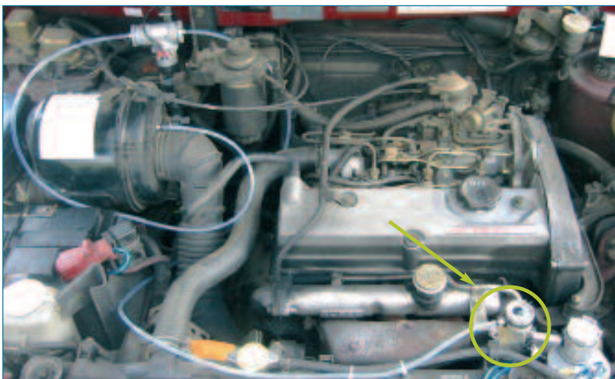
Une implantation sous capot très simple : le réacteur, une vanne de sécurité, la durit d'amenée de di-hydrogène
